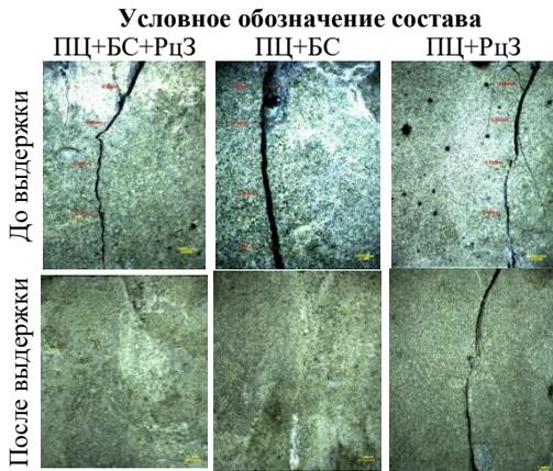
**Рис. 8.** Поверхности цементного камня до и после выдержки в растворе с прекурсорами
